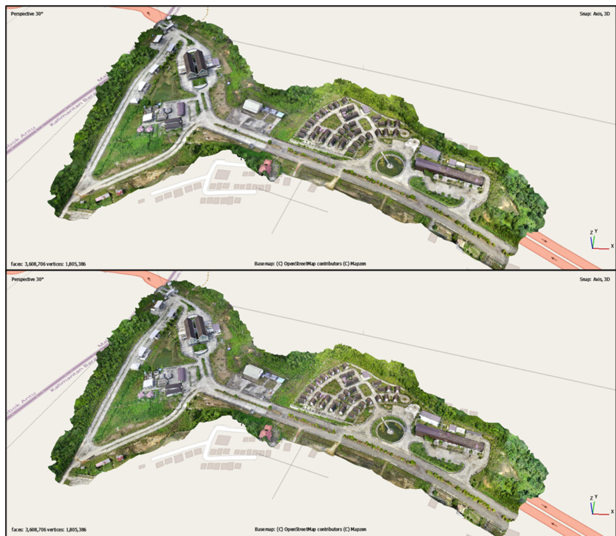
Gambar 14. Perbandingan tekstur model 3D antara model mesh (atas) dan model tiled (bawah).
