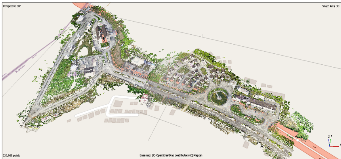
Gambar 11. Hasil pembuatan point cloud dari data fotogrametri.
