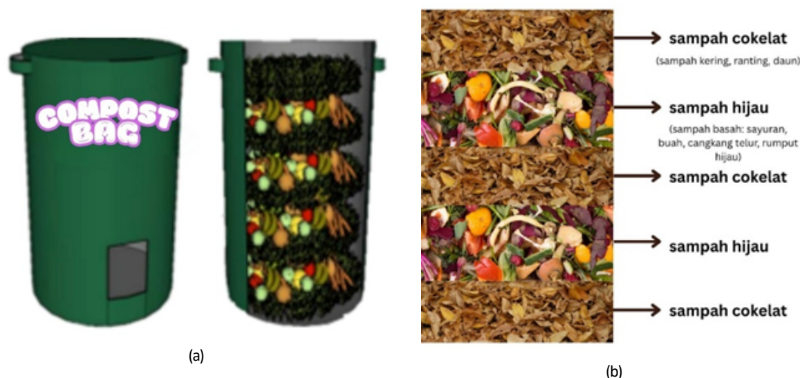
Gambar 3. Ilustrasi (a) dan susunan penempatan sampah pada composting bag (b)
