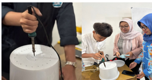
Gambar 2. Persiapan alat dan bahan (proses melubangi ember bekas untuk menambah sistem aerasi)
